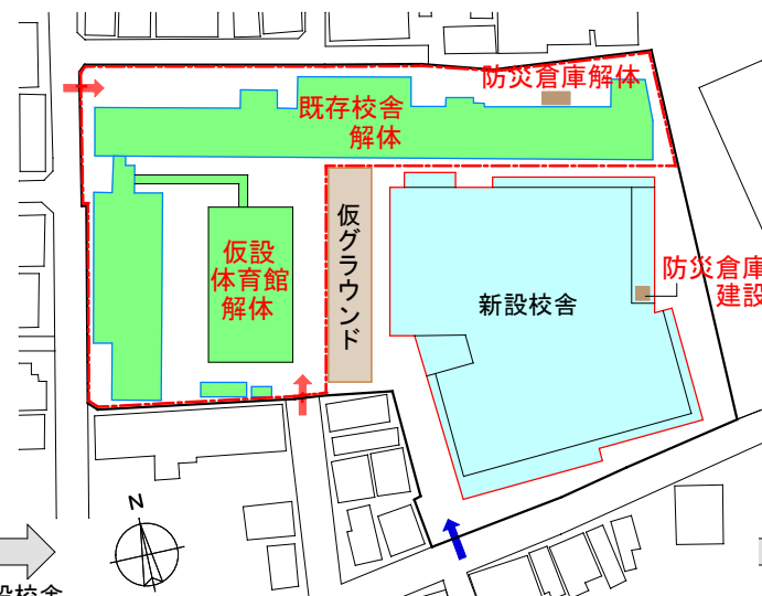
STEP5 仮設体育館・既存校舎 解体
