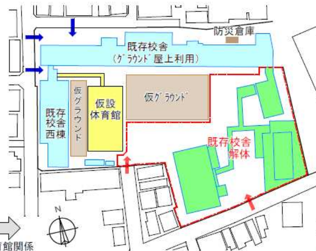
STEP3 既存校舍解体
