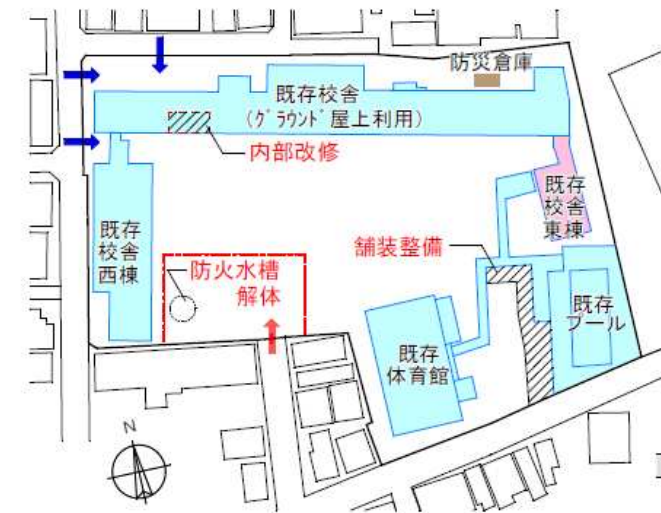
STEP1 舖裝整備、既存校舍内部改修、防火水槽解体
