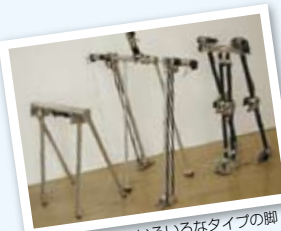
▲歩行ロボットのいろいろなタイプの脚
