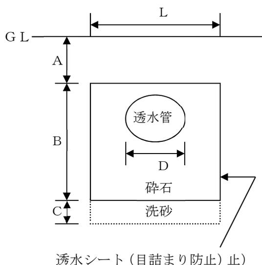
※ 浸透施設の設置には、地下水位を考慮してください。(地下水位は概ね地盤面より-1m以上)
