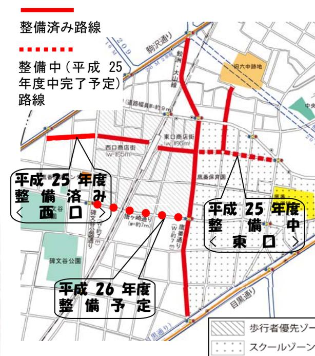
■ 舗装工事：舗装の全面カラー化等による他の路線との差別化及び歩行部の視認性確保による安全性の向上
