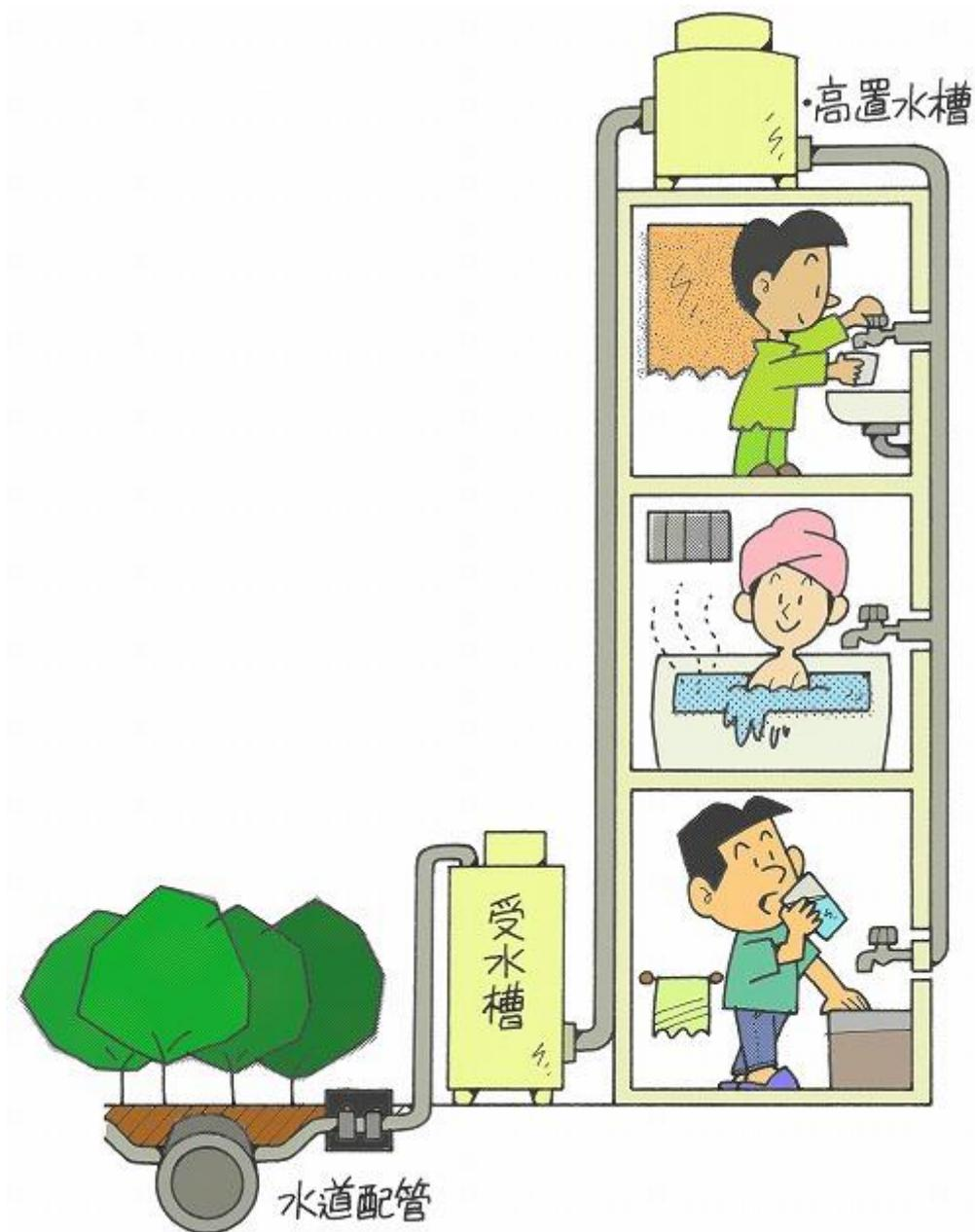
貯水槽を使用する給水施設のうち、水槽の有効容量が 10m<sup>3</sup> 以下のものを「小規模貯水槽水道」といいます。
