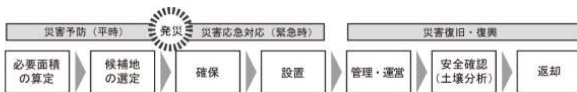
図2-5 仮置場の検討フロー（例）
